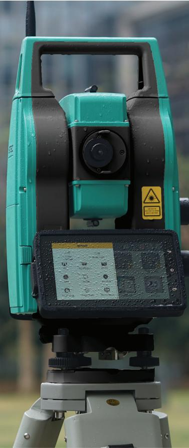
Construido con el servomotor más avanzado y potente de la industria, el AXIS10 ofrece más posibilidades y puede usarse en monitoreo o topografía.
